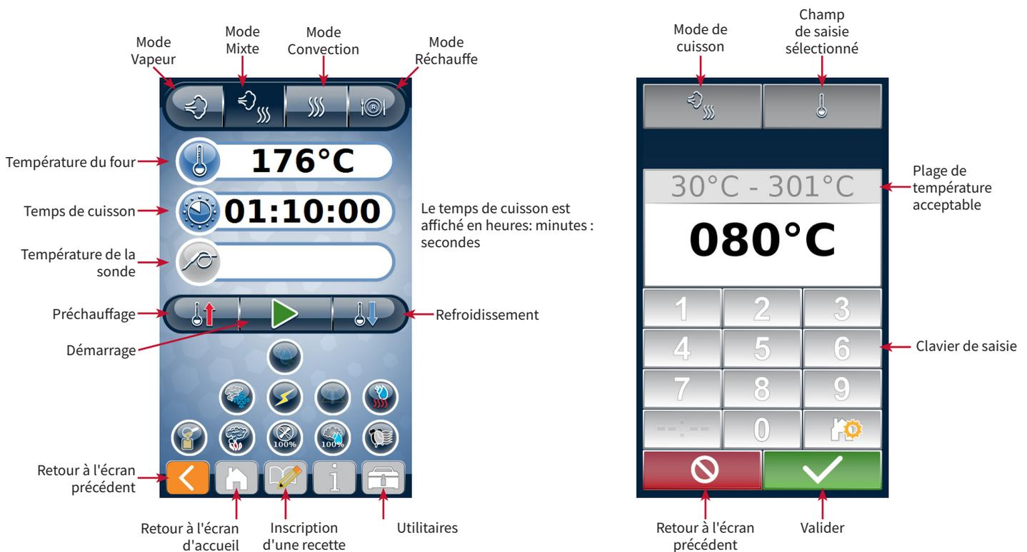
**REMARQUE :** lorsqu'un mode de cuisson est sélectionné, il est affiché en bleu foncé. Lorsque le mode de cuisson demande un appel de chaleur, il est affiché en rouge. Lorsque le mode de cuisson demande un appel d'humidité, il est affiché en bleu clair. Dans l'illustration ci-dessus, le mode mixte est sélectionné et demande de la chaleur. De même, la puissance PROpower™ est sélectionnée et la vitesse du ventilateur est réglée à 100 %.
